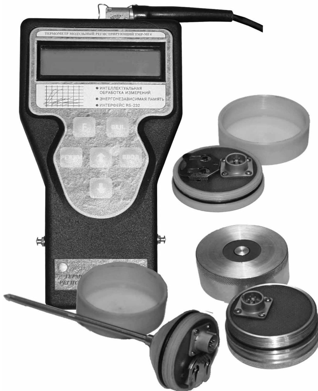
Рисунок 3.1. Общий вид термометра ТМР-МГ4 с модулями-регистраторами различного типа
